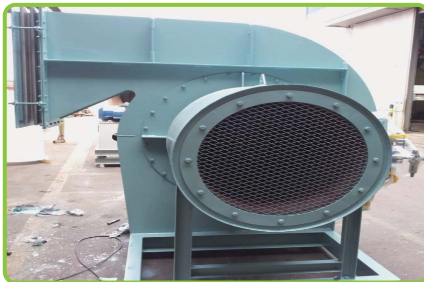
강제 압입 통풍 fan( Forced draft fan)
