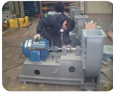
모터 조립 및 정렬 Motor Assembling & Alignment
