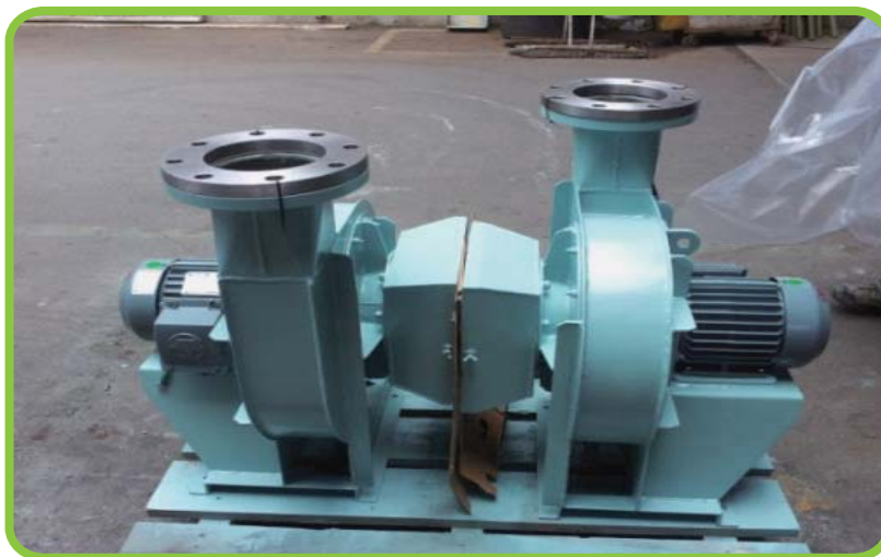
밸라스트 워터 처리 시스템 fan (BWTS fan)
